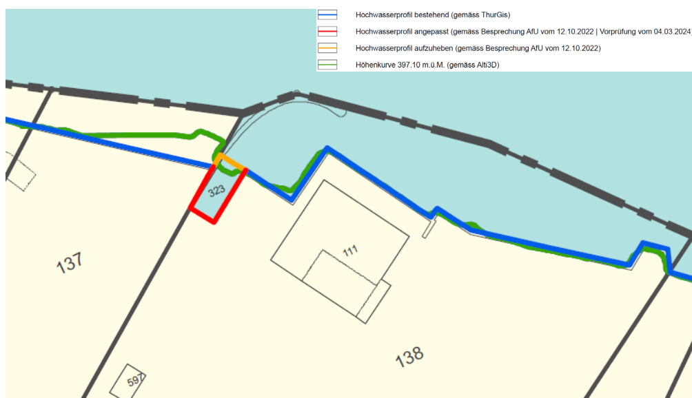
Planausschnitt "Hochwasserprofil", Parz. 137/138 (Seeriet West)
